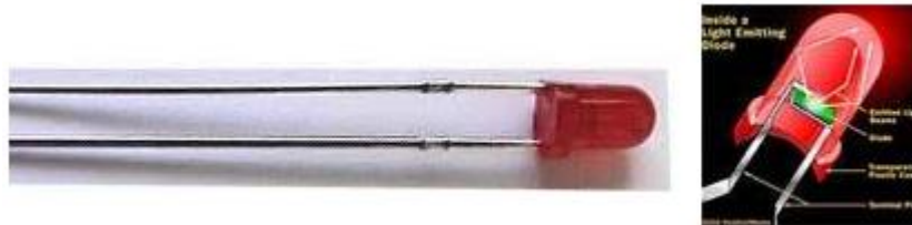
Hình 2.16: Hình dạng thực tế của diode phát quang (LED)
